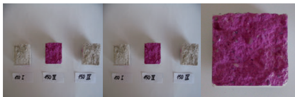
Obr. 8: Cyklus po 150 aplikacích, aplikace ručním rozprašovačem, aplikace jemným štětcem a bez aplikace vápennou vodou.
