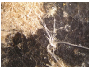
Obr. 9: Mikroskopický snímok zvyškov čierneho pigmentu nanoseného na papieri pri 10× zväčšení.
