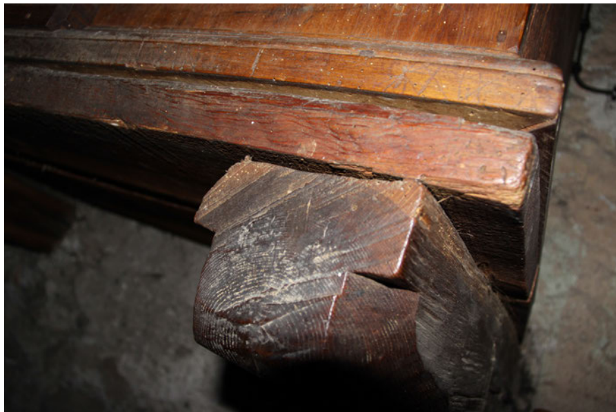
Obr. 3: Nosný trám organa. Je na ňom jasne vidno tangenciálnu štruktúru ročných kruhov od jadra až po belové drevo.
