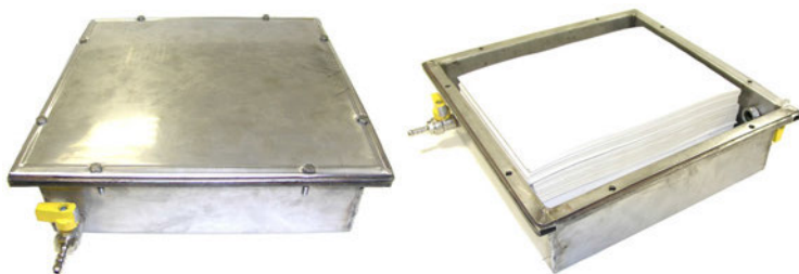
Obr. 2: Reaktor na výrobu homogénnych blokov predstarnutého testovacieho papiera.
