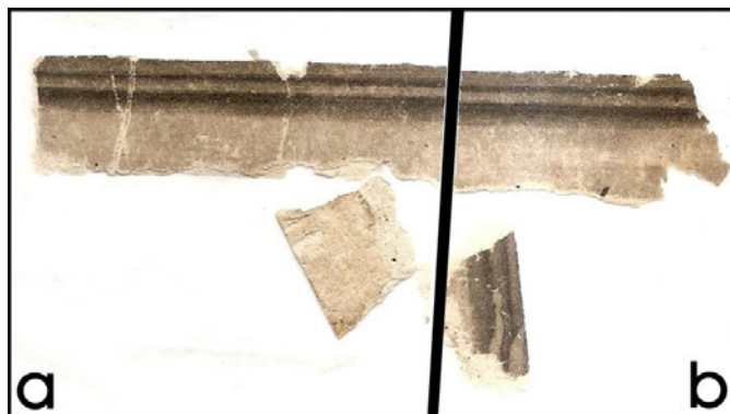
Obr. 6: Porovnanie vzorky podlepeného originálu testovaným lepidlom a) pred urýchleným starnutím, b) po 380 hodinách urýchleného starnutia.
