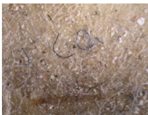
Obr. 11: Mikroskopický snímok vzorky papiera pri 4× zväčšení so silnou povrchovou úpravou papiera a množstvom nečistôt.
