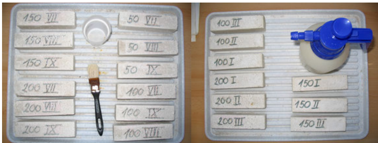
Obr. 1: Způsoby aplikace vápenné vody.
