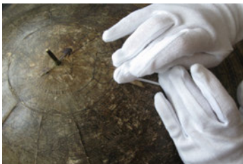
Obr. 3: Povrchové meranie pH pomocou pH papierikov na guli glóbusu.
