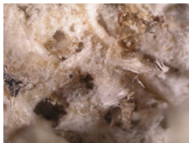
Obr. 6: 4× zväčšená puklina a foxing.
