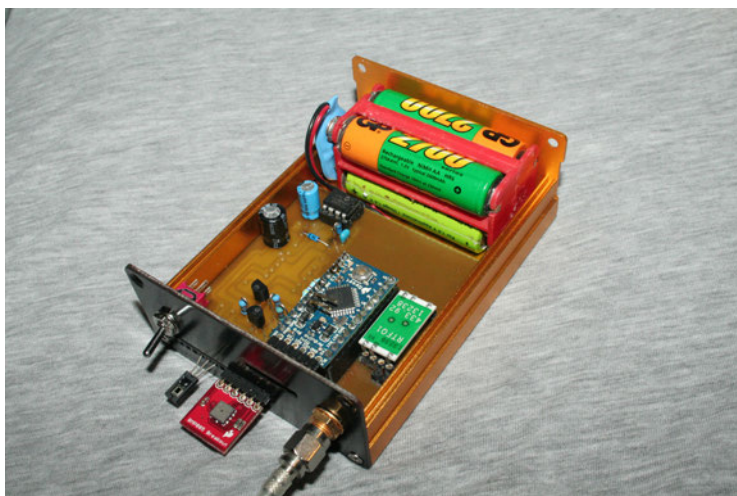
Obr. 1: Prototyp širší verze „modulárního“ senzoru.
