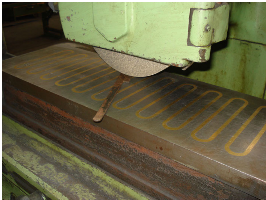
Obr. 5: Brúsenie – reštaurovanie profilovacieho noža.
