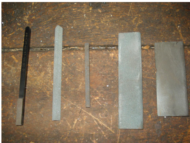
Obr. 6: Brúsne kamene použité pri presnom profilovaní ostria.
