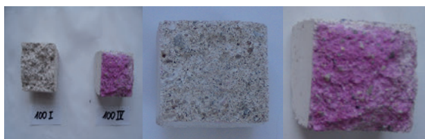
Obr. 7: Cyklus po 100 aplikacích, aplikace ručním rozprašovačem, aplikace jemným štětcem a bez aplikace vápennou vodou.
