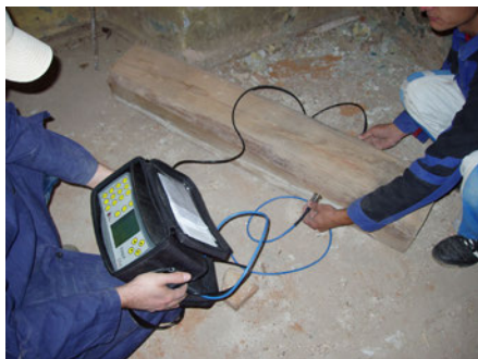
Obr. 1: Ultrazvuková analýza 1 m dlhého výrezu z asanovaného trámu.
