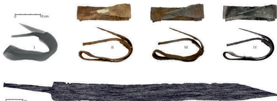
Obr. 7: Postup čistenia, konzervovania, dokumentovania a vizuálna rekonštrukcia meča.
