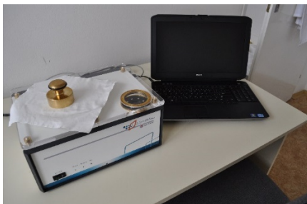
Obr. 1: Měřicí systém SurveNIR se skládá z vlastního spektrometru, softwaru speciálně vytvořeného pro jednotlivé materiály (papír, plast) a databáze.
