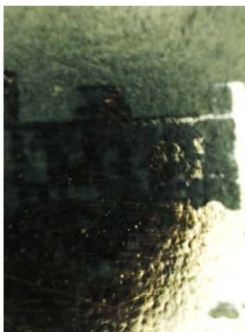
Obr. 4: Vľavo – diskolorácia laku na báze nitrocelulózy, zväčšenie 20x. Vpravo FTIR spektrum lakových vrstiev (zelená farba – nestarnutý kolódiový lak, modrá – kolódiový lak zostarnutý urychleným starnutím; čierna – modelový systém lakovanej DOP fotografie; červená farba – historická fotografia s pôvodnou vrstvou kolódiového laku).
