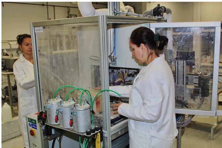
Obr. 4: Obsluha multifunkčného zariadenia – vyberanie modelových knižných blokov po absolvovaní konzervačného procesu. Vľavo detail 3 zásobných nádob pre konzervačné látky vo forme prášku.
