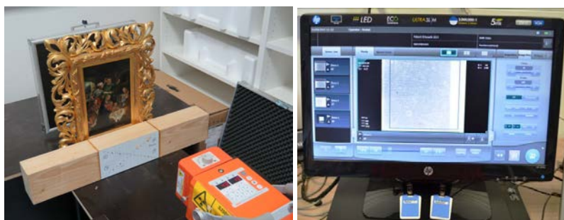
Obr. 9: Rentgenový přístroj (0,32 mAs, 0 - 40 kV), vpravo RTG snímek.
