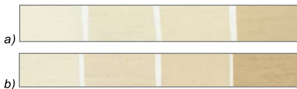
Obr. 12: Pauzovací papier (a) a pauzovací papier podlepený s fóliou (b) počas starnutia 0, 3, 6 a 36 dní.
