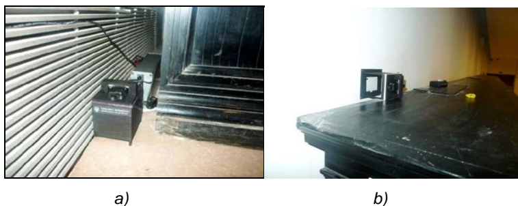
Obr.7: Senzory na detekci přítomnosti biologických škůdců umístěné ve výstavě „Archa“ v Nové budově Národního muzea: (a) senzor na detekci lezoucího hmyzu, (b) senzor na detekci polétavého hmyzu.
