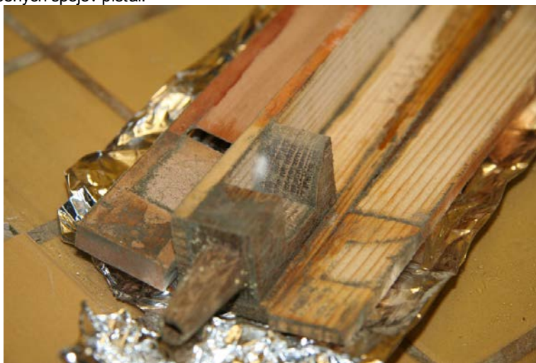
Obr. 10: Rozpadnutá experimentálna píšťala po pôsobení plesňami.
