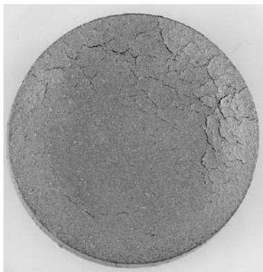
Obr. 2: Praskliny na povrchu tablety pyritu uchovávané po dobu 50 dní v prostředí s RH = 97 %.
