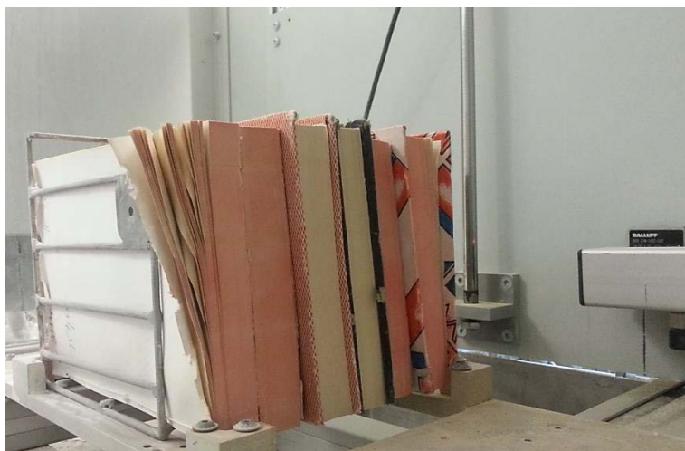
Obr. 3: Súbor knižných blokov v koši na vozíku zariadenia, umiestnený v obslužnej komore pred zatvorenou prepážkou oddeľujúcou obslužnú a procesovú komoru.
