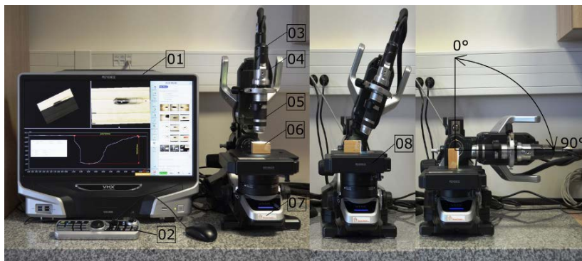
Obr. 3: Digitální mikroskop VHX-5000: 01. LCD monitor, 02. ovládací konzola, 03. kamera, 04. motorizovaná jednotka z-osy, 05. objektiv, 06. otočná a posuvná plocha, 07. stojan, 08. motorizovaná jednotka x, y osy. Hlavu s objektivem je možno natáčet až o 90^\circ .
