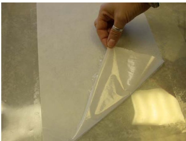
Obr. 3: Laminačná fólia – japonský papier s 3 % vodným roztokom Klucelu G.
