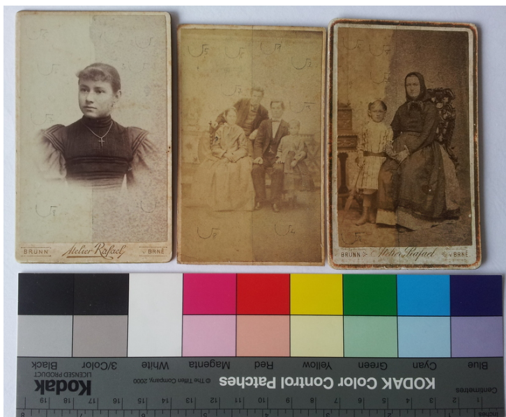
Obr. 6: Historické albumínové fotografie z antikvariátu ošetrené 0,5 % etanolovým roztokom \text{NaBH}_4 (pravá strana).
