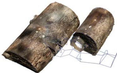
Obr. 1: Fotogrametricky spracovaný suterén západného krídla biskupského paláca spojený s geodetickým meraním (A. Arpáš, B. Balžan, M. Bartík).
