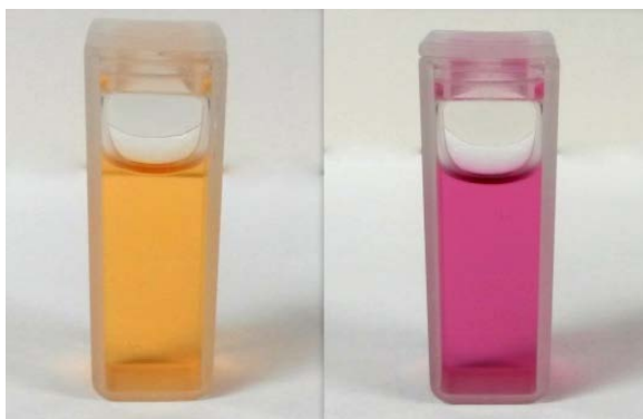
Obr. 6: Roztok kyseliny karmínovej s pH = 3 (naľavo) a pH = 8 (napravo).
