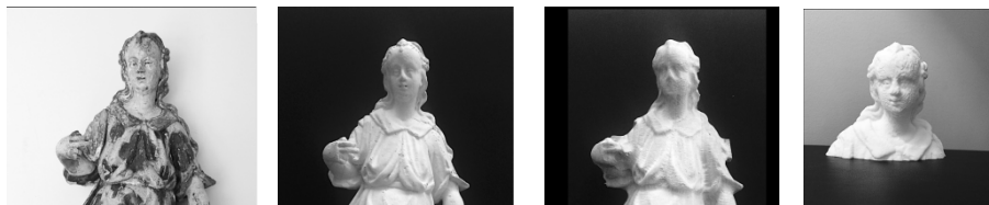
Ob. 11: Štyri exempláre sochy – originál a tri spôsoby vyhotovenia reprodukcí, slúžiacich na porovnanie výstupov a) originál sochy, b) sadrový odliatok, c) drevo Lipa 3D fréza, d) 3D SLS tlač.
