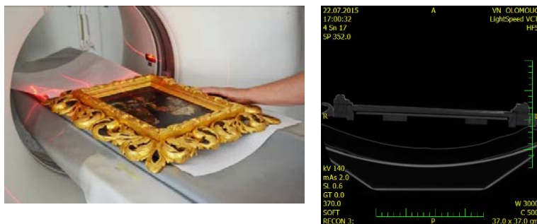
Obr. 11: Uložení a snímání objektu v tloušťkách 0,625 – 5 mm.
