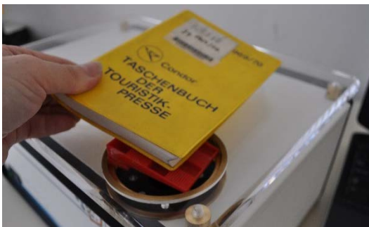
Obr. 4: Identifikace plastových obálek pomocí měřicího systému SurveNIR.
