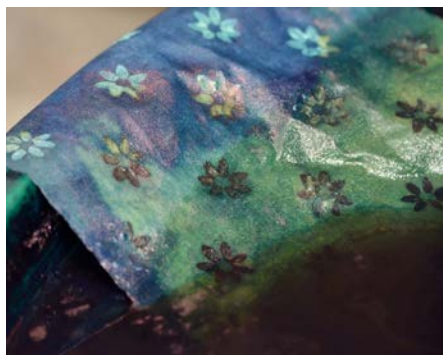
Obr. 4: Proces oxidácie kypového farbiva na tkanine potlačenu rezervou.
